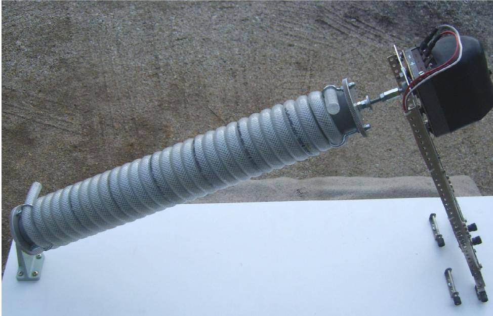
Abbildung 4: Unsere Archimedische Schraube – Grundaufbau; ohne Wasserbehälter (Quelle: privat)
