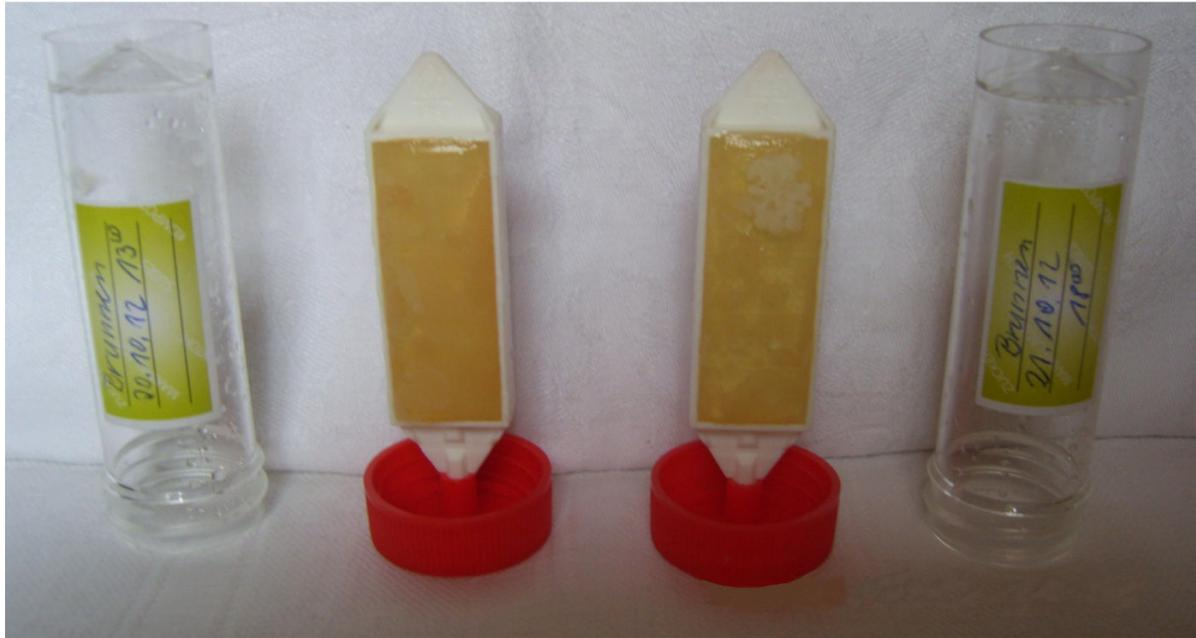
Abbildung 8: Vergleich Gesamtkeimzahl Brunnenwasser vor (linkes Bild) und nach der Sonnenbestrahlung am 24.10.2012 18.00 Uhr (Quelle privat)
