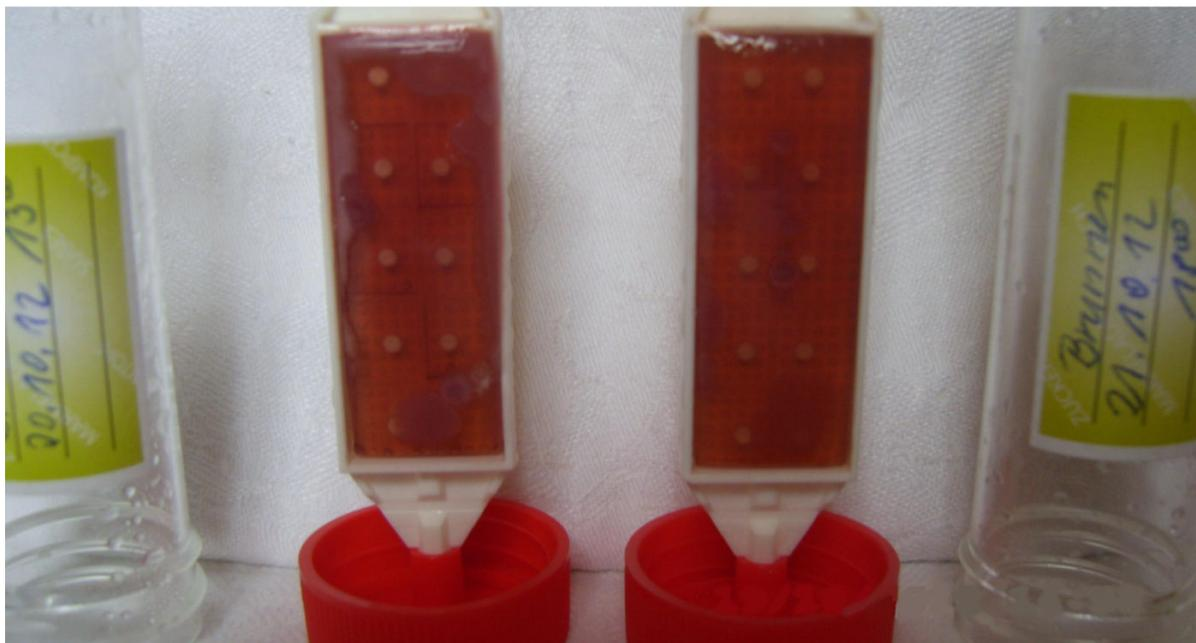
Abbildung 9: Vergleich coliforme Keime Brunnenwasser vor (linkes Bild) und nach der Sonnenbehandlung am 24.10.2012 18.00Uhr (Quelle privat)
