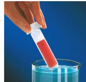
Abbildung 5: Eintauch- und Abklatsch Nährbodenträger
