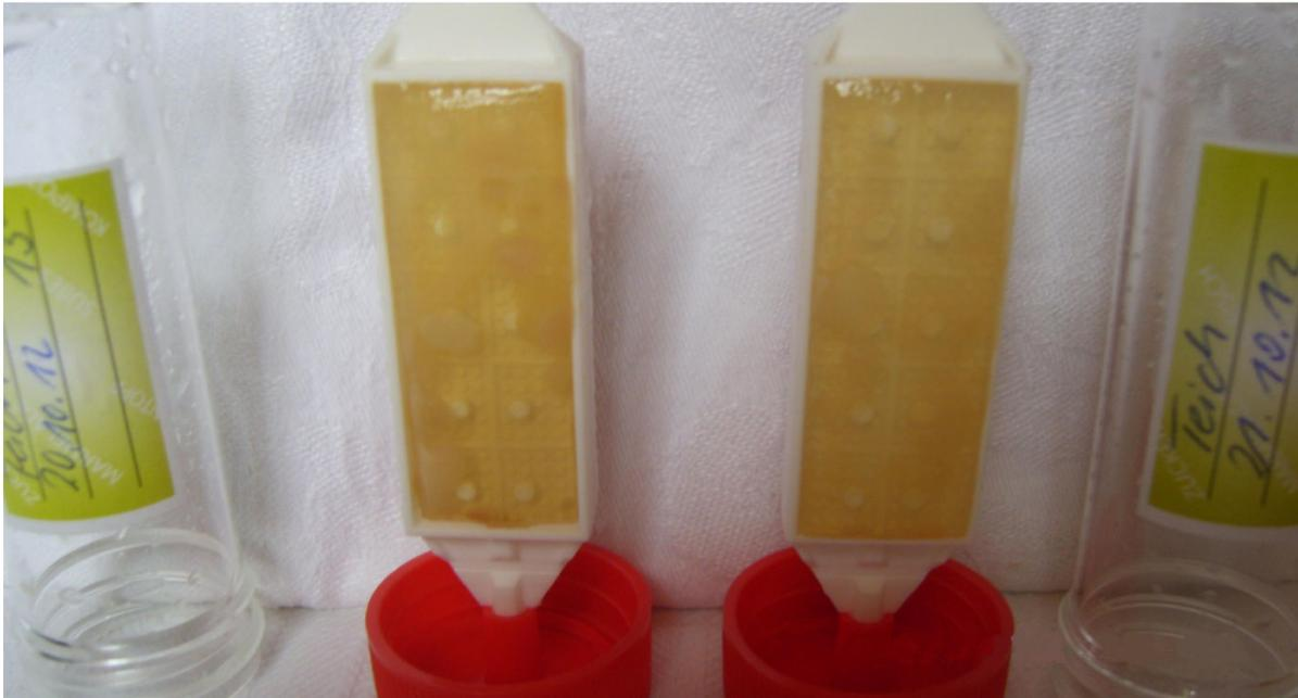
Abbildung 10: Vergleich Gesamtkeimzahl Teichwasser vor (linkes Bild) und nach der Sonnenbestrahlung am 24.10.2012 18.00 Uhr (Quelle privat)
